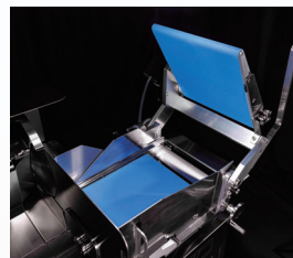
上押えにベルト方式を採用(※3)
