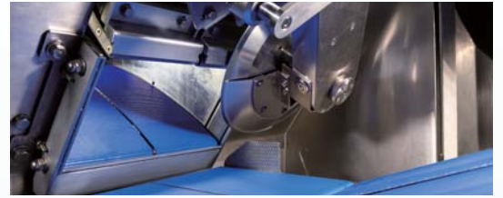
肉箱周辺の構造を変更。丸刃には新開発のはがし機構を搭載。
