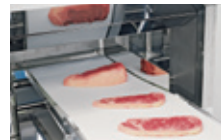
エンドロス排出で歩留り、作業効率アップ ※エンドロス排出とは、最後の不定形な部分をスライスせずに排出すること。
