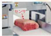
材料の形状を上下2個ずつの変位センサにより読み込み、自動でスライス開始。
