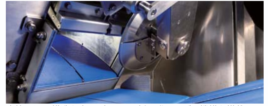
肉箱周辺の構造を変更。丸刃には新開発のはがし機構を搭載。
