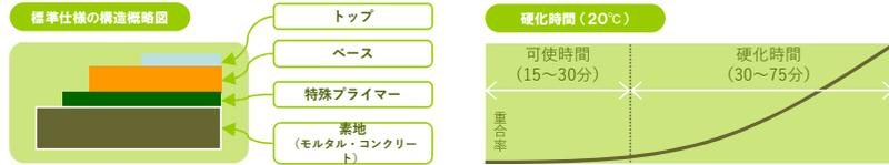
アクリトンフロアは、湿潤面に強力な接着力を有する特殊プライマーと、硬化時間が短い特殊モルタルを使用しています。湿潤状態のコンクリート上であっても、施工後約1時間程度で固まり、短時間での施工が可能となっています。また、マイナス30°C下でも硬化反応しますので、冷凍庫内などの低温下でも施工が可能です。
